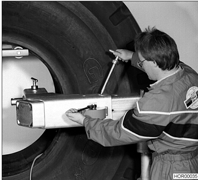
Bild 17 Positioning the left frame section
