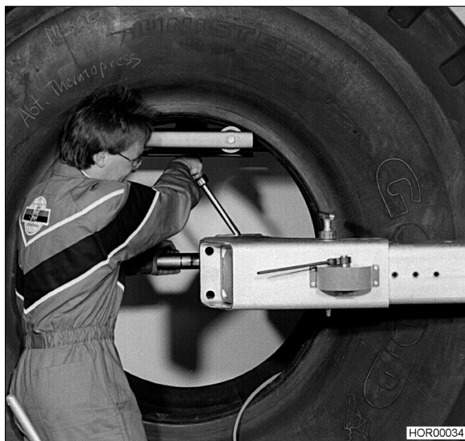
Bild 16 Positioning the left frame section
