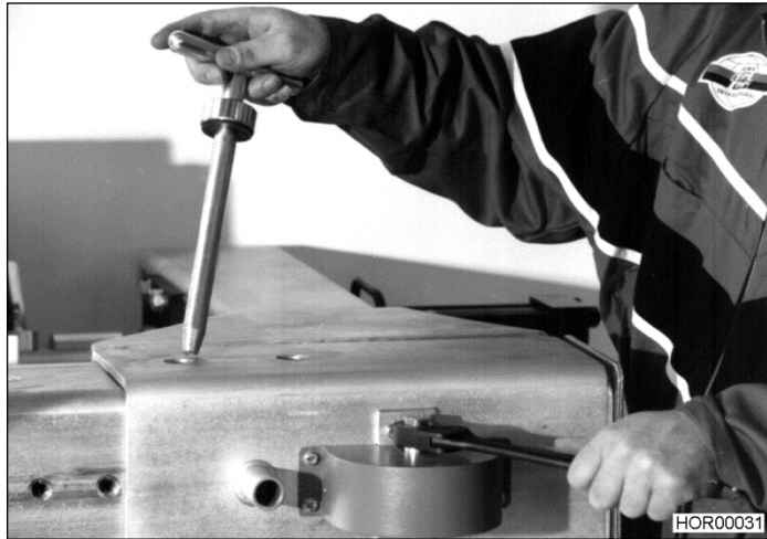
Bild 13 Positioning the frame sections
